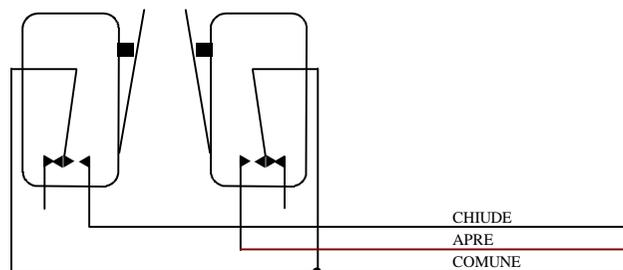
Caratteristiche generali: per rimuovere la plancia porta gruppo elettromeccanico; composto da un cilindro chiave, il quale tramite un fuori centro a molla, aziona gli switch apre, chiude, è necessario dopo avere rimosso la vite, inserire la chiave ruotarla tutta in senso di C = chiude, e tirare dolcemente finché tutto il gruppo esce dal contenitore. Stessa manovra per reinserirlo nel contenitore, facendo attenzione ad imboccare nella sede la guida superiore.
